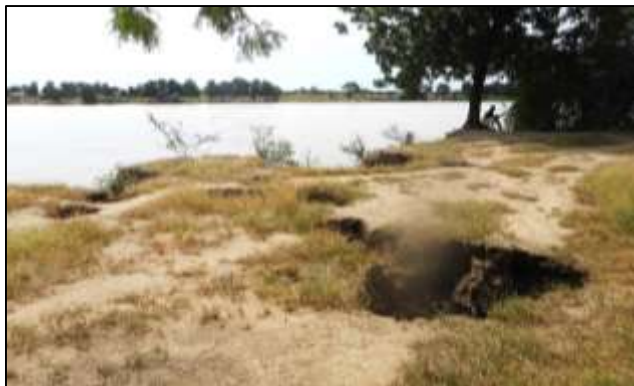
Photo 1 : « marmites » d'érosion conduisant au chenal par voie souterraine Prise de vue : Djébé M., septembre 2018
