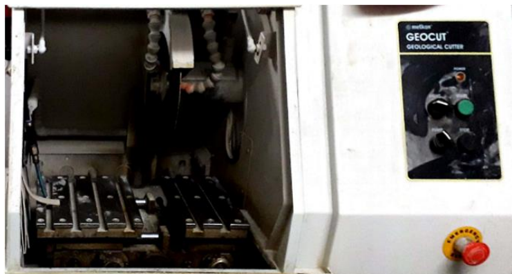
Figure 2 : Scie à lame diamantée pour la taille des cuirasses
