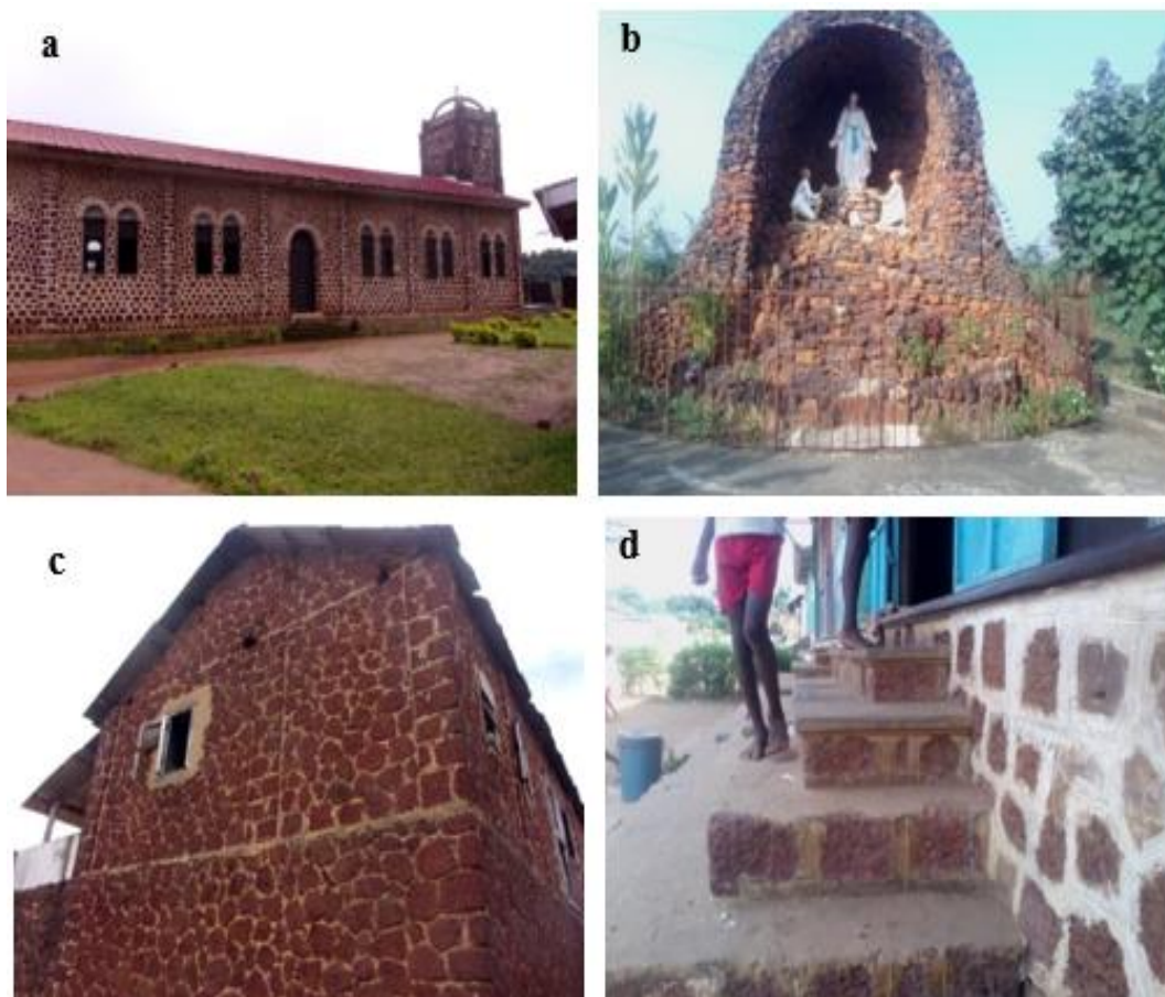
Figure 7 : Edifices construits avec la cuirasse
