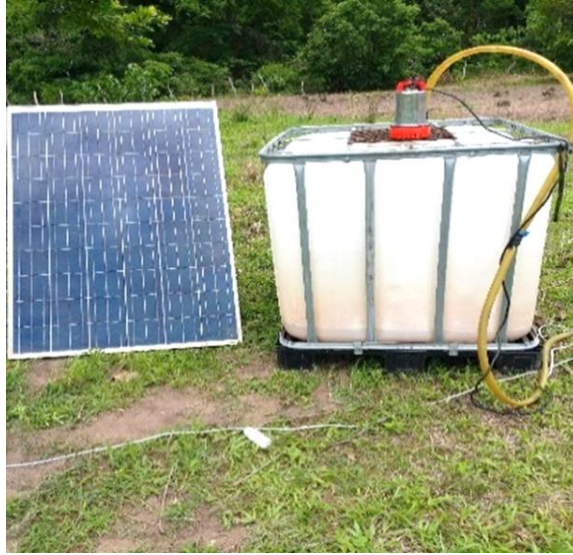
Figure 3 : Panneau solaire et réservoir de 1000 litres
