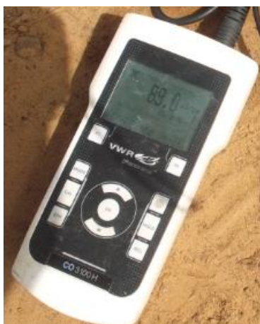
Figure 3 : Conductivimètre utilisé pour la mesure de la conductivité sur le site de Yaboni
