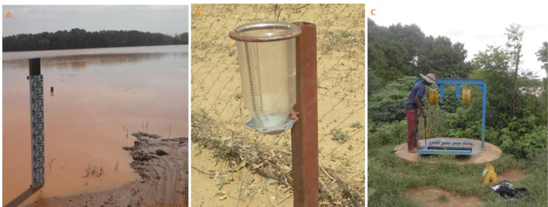
Figure 2 : A : Echelle limnimétrique, B : pluviomètre ; C : mesure du niveau piézométrique avec une sonde piézométrique
