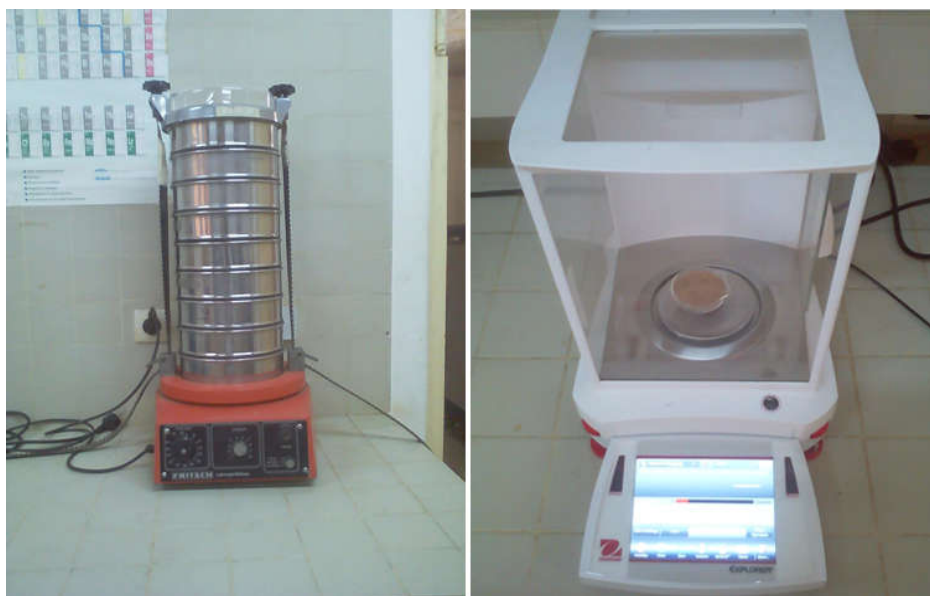
Figure 4 : Protocole d'analyse granulométrique au laboratoire des sédiments
