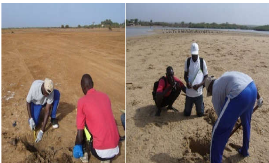
Figure 3 : Échantillonnage par carottage sur les bancs sableux et les tannes au niveau complexe laguno-estuarien de la Somone
